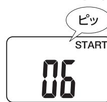
吹きかけ口から1cm程離して、約4~5秒間息を吹きかけます。息を吹きかけると「ピー」と音が鳴り続けます。音が鳴っている間は息を吹きかけ続けてください。「ピッ」と音がしたら、測定完了です。
